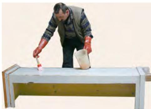
*Bei diesem Schrank tut sich beim Laugen wenig. Deshalb wird er mit Paste eingestrichen.*
